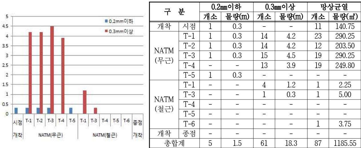
【표 1.1.9】 측벽부 수직균열 및 망상균열 발생 현황
